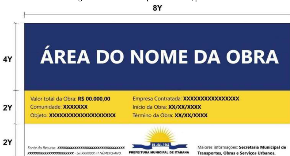
Imagem 01 – Modelo da placa de obra, padrão PMI
