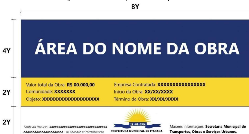
Imagem 01 – Modelo da placa de obra, padrão PMI
