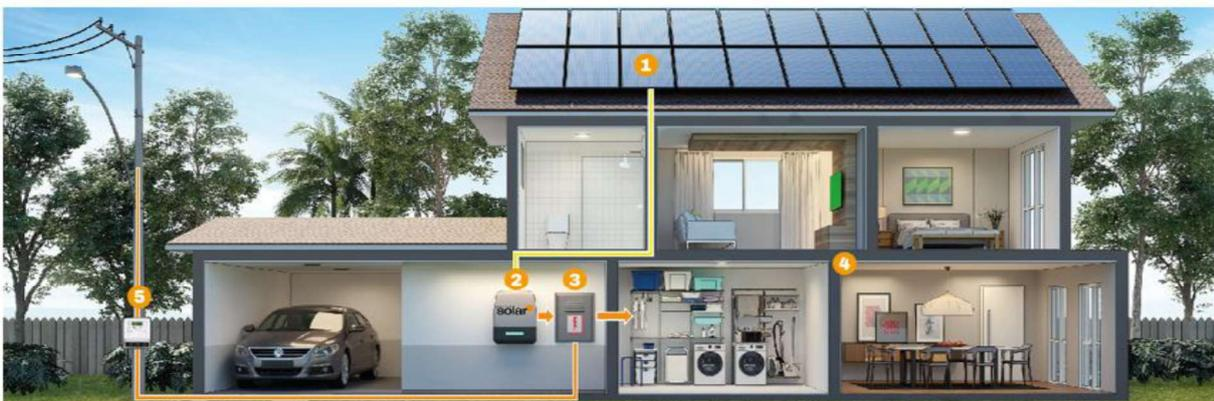
A energia elétrica que sai do inversor solar vai para o seu "quadro de luz" e é distribuída para sua casa ou empresa, a energia que não for utilizada vai para a rede da distribuidora passando por um relógio bidirecional, que é instalado pela distribuidora, gerando créditos de energia. Estes créditos podem ser utilizados durante o período da noite, momento em que não temos incidência solar e geração de energia fotovoltaica.
