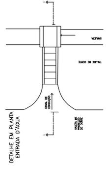
**DETALHE EM PLANTA ENTRADA D'ÁGUA**
