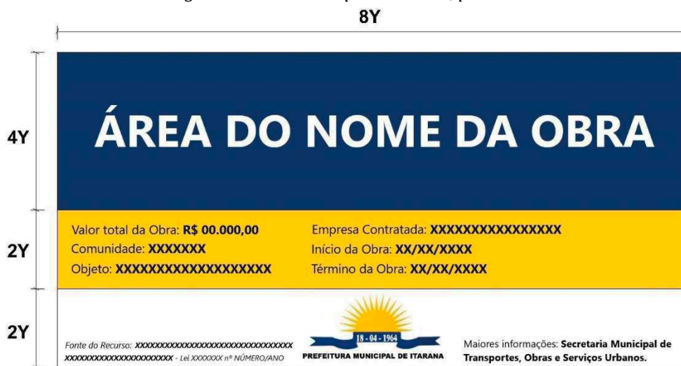
Imagem 01 – Modelo da placa de obra, padrão PMI
