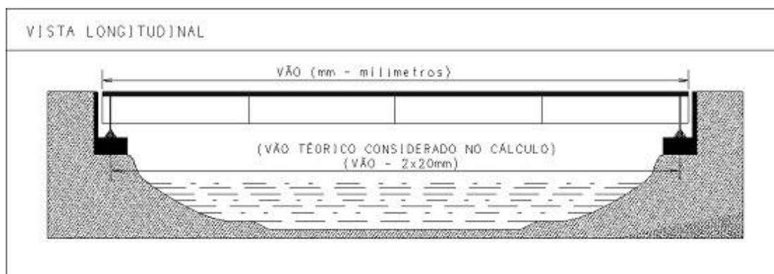
Figura 02: Vista longitudinal típica considerada para dimensionamento das longarinas
